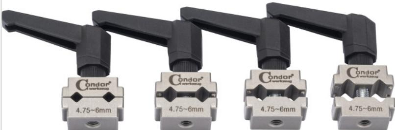
Bremsleitungs-Halteklemmen für Biegearbeiten an der Bremsleitung , dieses 4-teilige Set ermöglicht Ihnen das exakte Nachbilden der alten Bremsleitung. Ermöglicht das parallele Fixieren von alter und neuer Bremsleitung beim Biegevorgang. Es entsteht durch die Klemmung keine Veränderung am Durchmesser der Leitung, geeignet für Leitungen mit Ø 4.75- 6 mm aus Kupfer, Stahl und kunststoffbeschichtete Leitungen.
